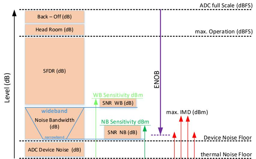
Δ Fig. 4 ADC parameters at a glance
